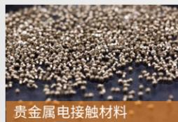
贵金属电接触材料
