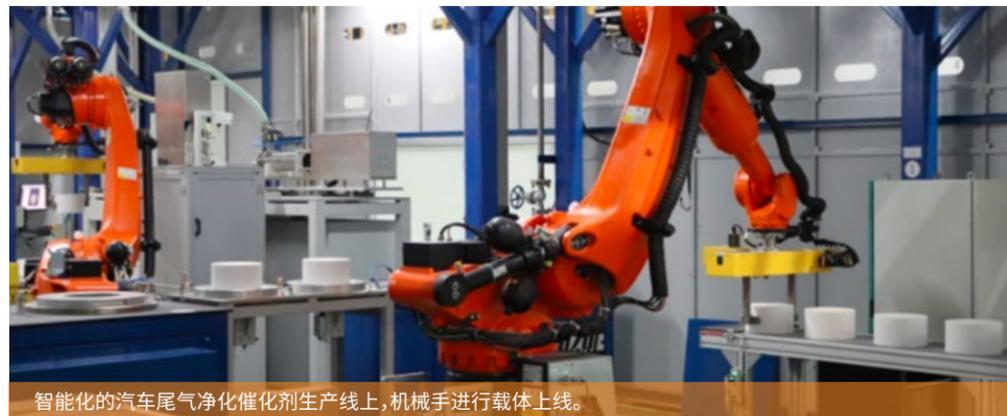
智能化的汽车尾气净化催化剂生产线上，机械手进行载体上线。
